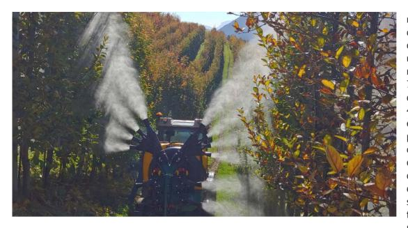
Il sistema EPA 2.0 controlla la dose di miscela (l/ha) irrorata al variare della velocità della trattrice rilevata tramite **GPS**
