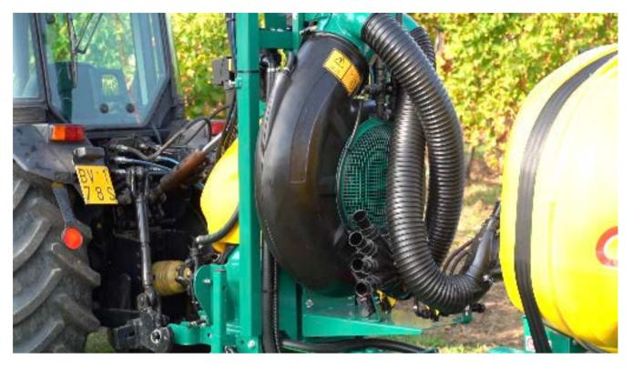
della vegetazione e garantiscono l'irrorazione ottimale a inizio e fine filare, nonché l'interruzione del trattamento nel caso in cui vi sia assenza di vegetazione lungo il filare. Durante l'irrorazione, EPA 2.0 registra i dati di lavoro in tempo reale. Al termine dell'irrorazione (o della giornata) l'operatore può collegare la chiavetta USB al computer aziendale e visualizzare tutti i dati di lavoro registrati, grazie al Kit Easy Farm.
