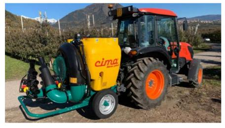
Alcuni atomizzatori portati sono dotati di ruote di appoggio al suolo che consentono una maggiore stabilità
