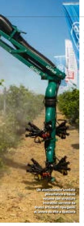
irroratore portato dal sollevatore del trattore mentre il serbatoio contenente la miscela da irrorare viene trainato tramite timone agganciato al telaio che sorregge il gruppo irroratore. Il posizionamento avanzato del gruppo irroratore rispetto al serbatoio consente di irrorare le piante collocate a fine filare, bloccare l'irrorazione e iniziare subito la manovra di inversione per entrare tra i filari ancora da trattare.
