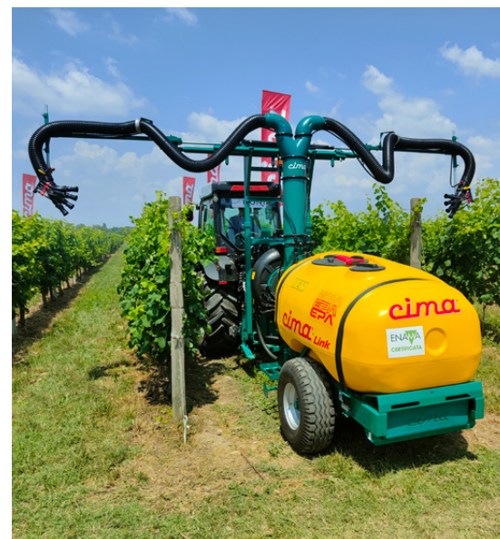
Atomizzatore pneumatico snodato Link in differenti configurazioni
