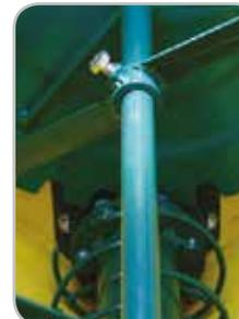
> **Agitateur à palettes** disposé dans le réservoir. Alimentation par vis sans fin hélicoïdale avec broyeur intégré. Vis sans fin et agitateur débrayables.
