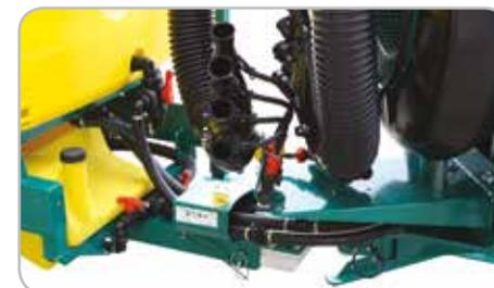
> Le joint articulé permet d'avoir un rayon de braquage très court sans le cardan homocinétique et grâce aux différentes régulations, les roues du chariot font le même tracé des roues du tracteur (brevet N.1312881).
