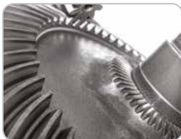
> **Multiplicateur** à couple conique à dents hélicoïdales.
