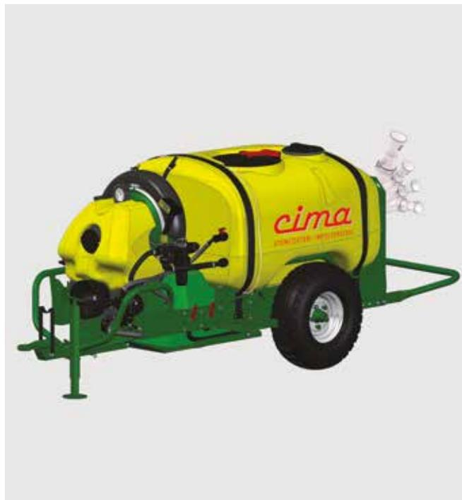
Le pulvérisateur trainé série **BLITZ 50** à pulvérisation pneumatique basé sur le principe du "tube Venturi", permet d'effectuer des traitements phytosanitaires avec un bas volume d'eau. Bien qu'il ne nécessite pas de tracteurs de forte puissance, ce pulvérisateur est le choix optimal pour le traitement de grandes extensions viticoles. Très peu d'entretien, frais de travail minimisés.
