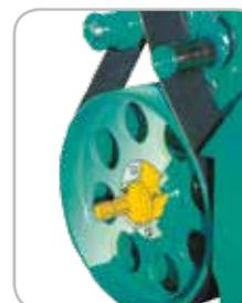
> Transmisión con correa poly-V, que absorbe los esfuerzos. Funcionamiento por más de 5000 horas. El tensor automático evita el deslizamiento y, en consecuencia, el desgaste. La calidad de la pulverización permanece inalterada en el tiempo.
