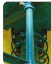
> Agitador rompemasa de palas. Tornillo sin fin de alimentación con espirales contrapuestas, con triturador / distribuidor. Embrague de seguridad para el agitador/tornillo sin fin.
