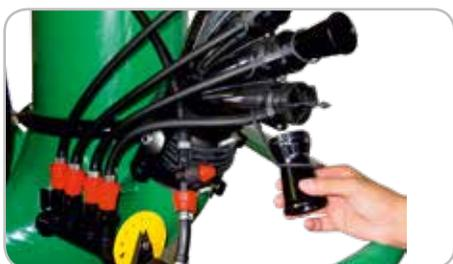
> Amplia gama de **cabezales** de distribución, todos equipados con el nuevo sistema antigoteo (pat. N.º 1745659) y dispositivos de difusión (manos y/o cañones) de diferentes dimensiones, de altura regulable, orientables e intercambiables, para garantizar una excelente cobertura y penetración en cualquier tipo de cultivo.
