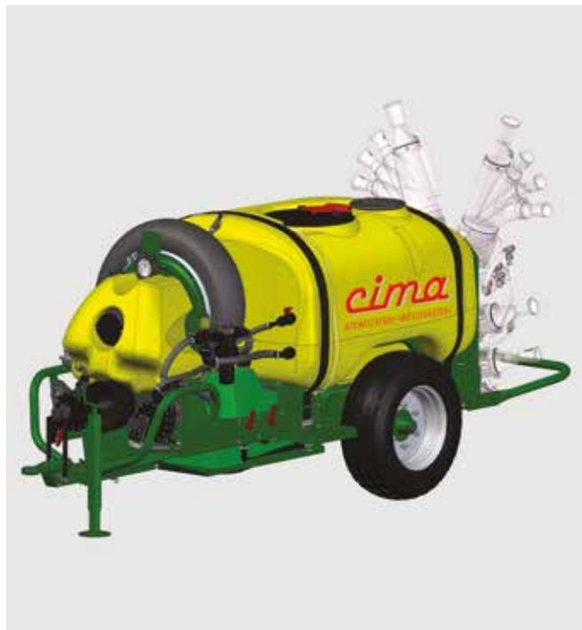
El atomizador remolcado serie **Blitz 55** de nebulización neumática, basada en el principio del tubo Venturi, permite realizar tratamientos botánicos utilizando mezclas con bajo volumen de agua. Este modelo, el más eficiente de la serie, combina la reconocida solidez de su estructura con elevadas prestaciones, garantizando un óptimo rendimiento en amplias extensiones vitícolas y frutícolas. Mantenimiento limitado, con costes de funcionamiento extremadamente reducidos.
