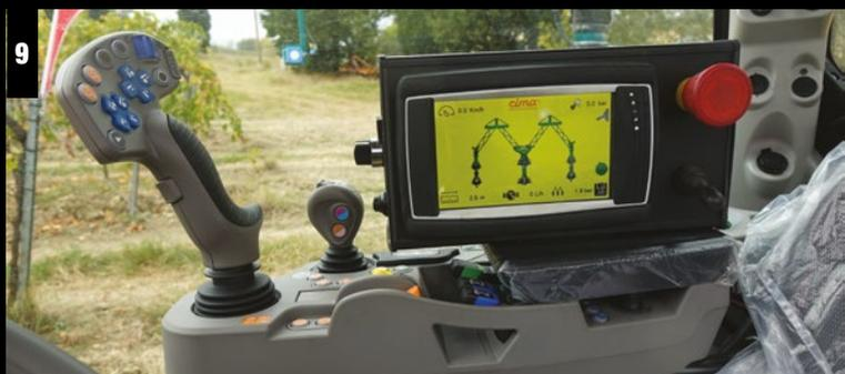
in tempo reale. Le calate sono, inoltre, manovrabili separatamente, per poter garantire una rapida ripresa del trattamento a fronte di manovre eseguite in capezzagne particolarmente anguste. Il software di controllo permette, in modo automatico, l'apertura e la chiusura dei bracci, riportandoli alla larghezza precedentemente impostata, oltre a gestire ogni singolo movimento in modo fluido, veloce ed efficace.
