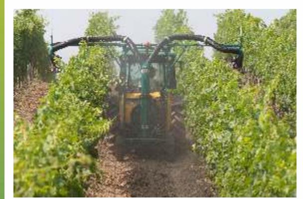
Testata Ripiegabile idraulica 2 Mani + 2 Mani a quattro diffusori. L'azione combinata delle mani, ed il flusso d'aria contrapposto dei diffusori, garantiscono un'ottima copertura oltre ad un importante abbattimento della deriva. Senza impiegare trattori di elevata potenza, consente il trattamento simultaneo di due filari ad ogni passaggio anche in vigneti dove non è possibile percorrere il filare adiacente, tipo sesti d'impianto terrazzati.
