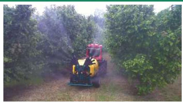
Trattamenti su alberi da frutto con differenti tipologie di allevamento. Alta penetrazione e grande copertura. Impiego con trattori di potenza 70-80 CV. La testata è composta da 4 cannoni inferiori orientabili e 2 mani superiori a 4 diffusori, l'orientamento delle mani superiori è regolabile idraulicamente dal posto di guida.
