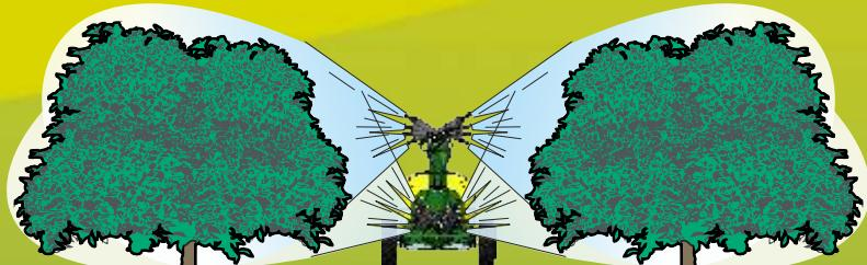
Soluzione innovativa per la protezione delle piante da frutto con alta densità delle chiome, composta da due mani inferiori e due mani superiori a 4 diffusori indipendentemente orientabili. L'orientamento delle mani superiori è regolabile direttamente dal posto di guida. La testata consente, ad ogni passaggio, la copertura contemporanea di entrambi i lati della pianta, assicurando una perfetta penetrazione della parte trattata.
