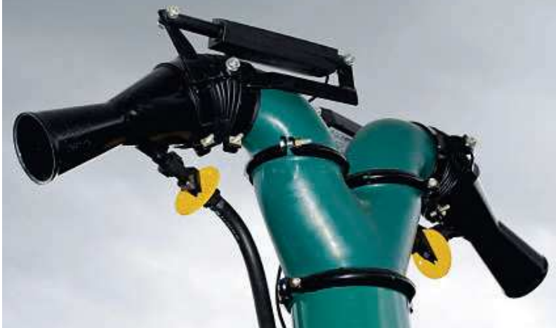
Le bocchette del cannone superiore si regolano tramite attuatori elettrici
