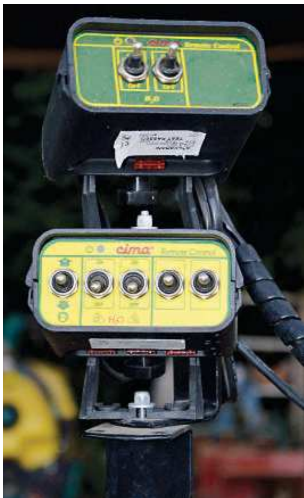
Controlli analogici per l'irroratrice. Il proprietario non ha voluto la gestione elettronica, offerta come optional
