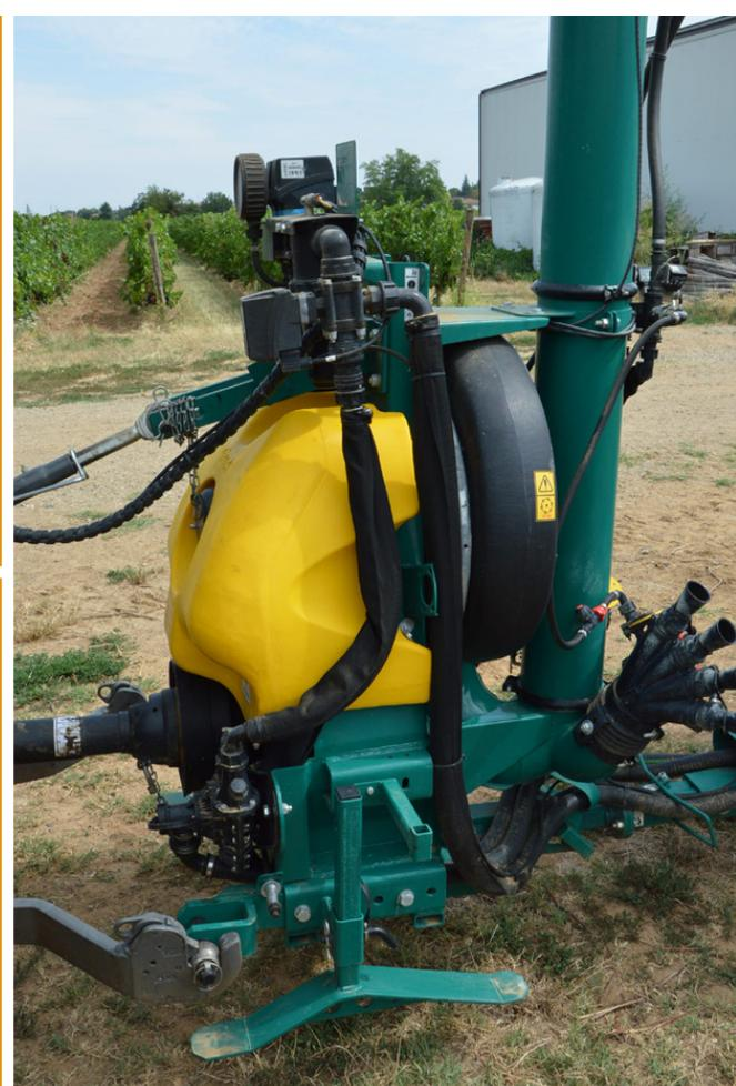
Pompa, diffusori e impianto lavamani sono collocati sull'attacco a tre punti. In questo modo si riduce il peso della parte trainata e di conseguenza il compattamento del terreno
