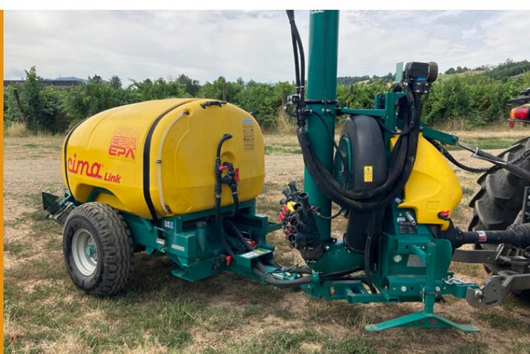
Link è un atomizzatore a basso volume, composto da due elementi separati: una soluzione brevettata a suo tempo da Cima
