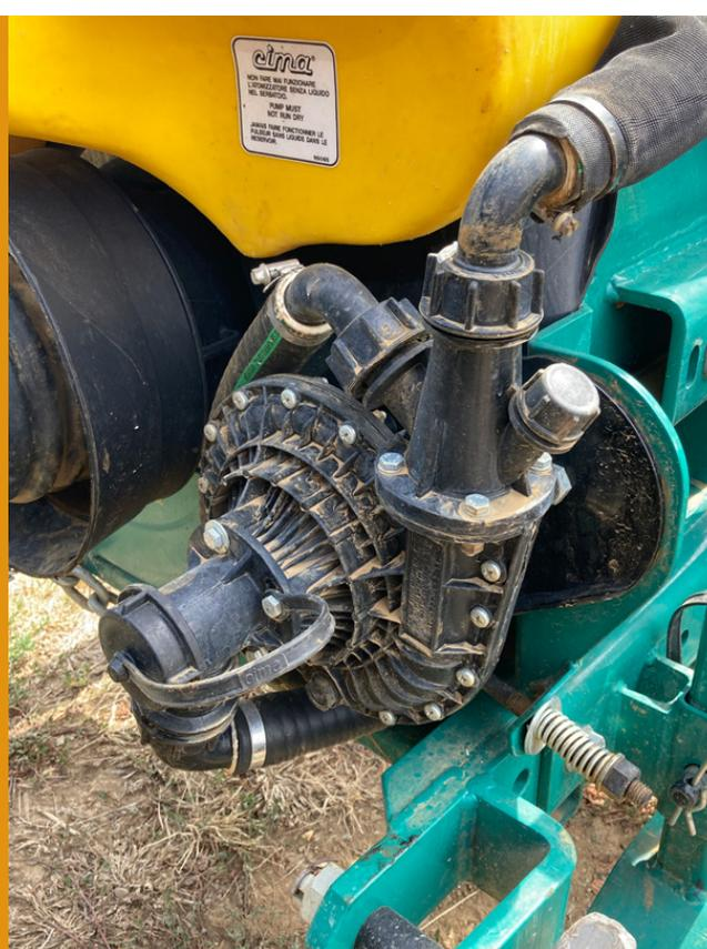
Pompa centrifuga da 140 litri al minuto: più che sufficienti ad alimentare un atomizzatore che lavora secondo il principio del tubo Venturi
