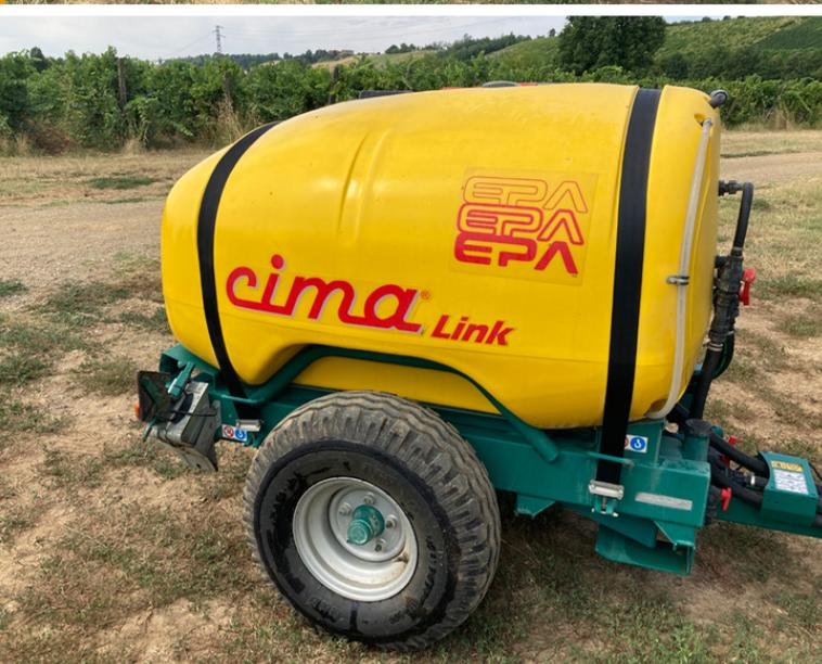
La botte, con capacità da 800 a 1.500 litri, è trainata ma, vista la lunghezza ridotta, risulta molto più maneggevole di un normale atomizzatore a rimorchio
