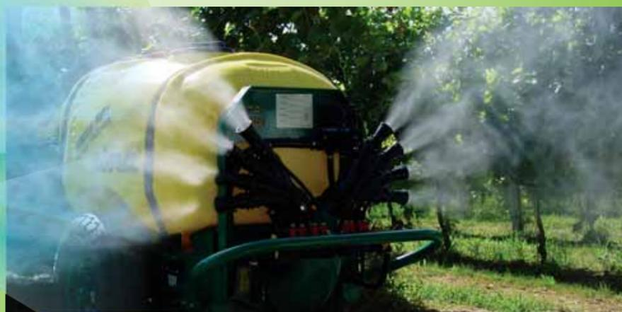
Les pulvérisateurs pneumatiques CIMA sont basés sur le principe du "tube Venturi". Une turbine centrifuge crée un volume d'air à vitesse élevée. Le liquide de traitement est déposé sans pression au centre du venturi qui à l'aide de la grande vitesse de l'air le pulvérise sur la végétation en très fines gouttes de 100/150 microns. Ce principe est la "PULVERISATION PNEUMATIQUE".
