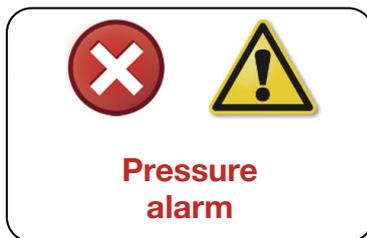
Esta notificación también se muestra cuando se detecta un valor de baja presión (mal funcionamiento de la bomba o de la válvula reguladora de presión). Si la presión de operación cae por debajo del valor mínimo o excede el valor máximo, el valor de presión en la EPA 2.0 cambia a rojo intermitente, lo que indica que la operación se realiza a más del  $\pm 30\%$  de la velocidad establecida.
