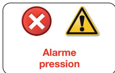
Ce signal apparaît également lorsqu'une valeur de pression trop basse est détectée (anomalie de fonctionnement de la pompe ou du clapet de régulation de la pression). Si la pression de fonctionnement tombe au dessous de la valeur minimale ou dépasse la valeur maximale, sur l'EPA 2.0, la valeur de la pression devient rouge clignotante, et indique qu'on travaille à une vitesse différente de  $\pm 30\%$  de la vitesse réglée.
