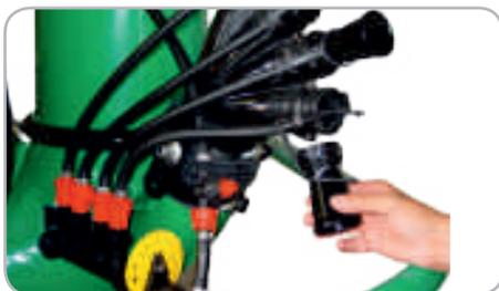
> Ampia scelta di **testate** di distribuzione, tutte dotate del nuovo sistema anti-sgocciolamento (brev. N°1745689) e di dispositivi di diffusione (mani e/o cannoni) di diverse dimensioni, adattabili in altezza, orientabili ed intercambiabili per garantire, su tutte le tipologie di colture, un'eccellente copertura e penetrazione nella vegetazione.
