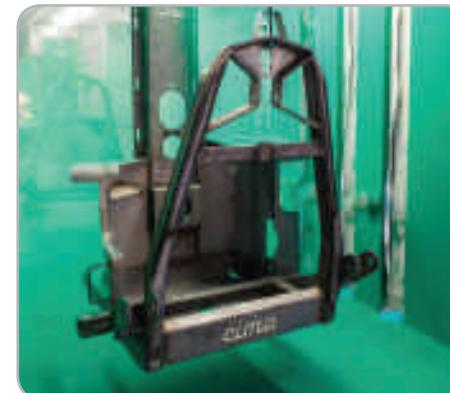
> **Verniciatura elettrostatica** con polvere poliestere dei componenti
