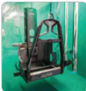
> **Verniciatura** elettrostatica con polvere poliestere dei componenti
