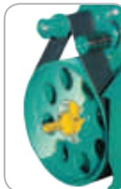
> **Trasmissione a cinghia poly-V** che assorbe le sollecitazioni. **Funzionamento per oltre 5000 ore**. Il tenditore automatico evita lo slittamento e quindi l'usura. La qualità della polverizzazione resta inalterata nel tempo.
